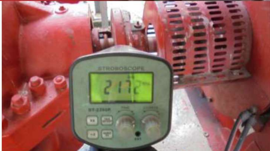
ความเร็วรอบของปั้มน้ำและเครื่องยนต์ที่อัตราการไหล 100%
