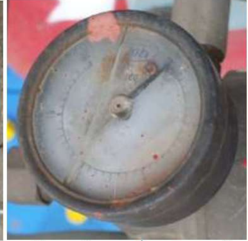
เกจวัดความดันของวาล์วระบายความดัน
